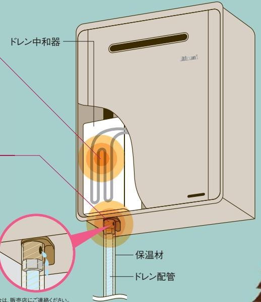
万が一、ドレン配管が凍結してもオーバーフロー排水口から排水します\*。
