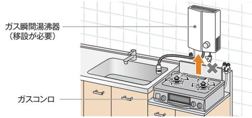
移設が困難で、やむをえずガスコンロの直上に設置する場合は、処置として下記の防熱カバーを取り付けてください。
