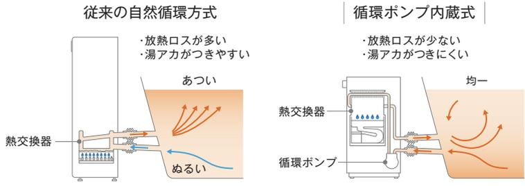
循環ポンプ内蔵の強制循環方式を採用し、おいだき用熱交換器に湯アカがつきにくく、また、放熱ロスの少ない構造のため、浴槽のお湯が冷めにくくなりました。釜鳴りの心配もありません。
