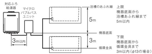
○配管途中の障害物:配管の途中に障害物がある場合は、高さ3m以内で1カ所として下さい。
