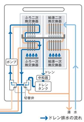
中和したドレンを一時的にドレンタンクに溜めます。溜まったドレンを既設のおいだし配管を利用して浴室へ搬送し、ドレン排水切替ユニット(三方弁ユニット)を作動させ排水口へドレンを排水します。(タンク内に一定量のドレンが溜まると通常自動湯はり時に排水。排水後は配管洗浄を行います。また、配管洗浄中に給湯した場合はお風呂と同温度での出湯となります。)
