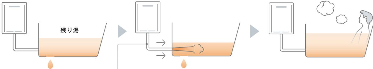
残り湯が循環金具付近まで減ると、循環金具から約5Lのお湯を流し、おいだき配管内に残ったお湯を排水します。
