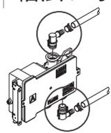
さまざまな種類のおいだし配管に対応する接続管セット(配管継手)
