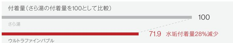
【実験方法】ガラス板に約1L/分の条件で試験水を流水。流水、乾燥各1時間を1サイクルとし、100サイクル経過後のカルシウム付着量を
