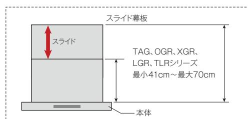
スライド前幕板 天井高に合わせてレンジフードの高さを調整可能。多彩なキッチンに、フレキシブルに対応できます。
