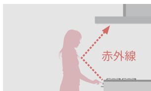
ビルトインコンロの点火／消火が、レンジフードの運転／停止と自動で連動。
