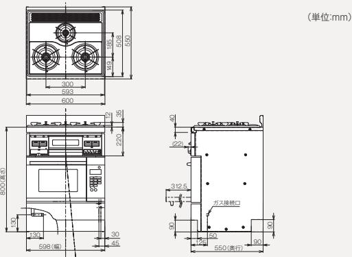
●図は機器として60cmタイプコンロとRSR-S14Eを組み付けた状態です。
