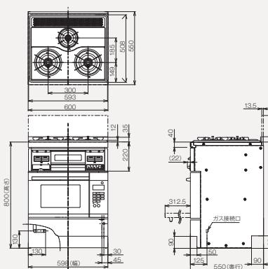
●図は機器として60cmタイプコンロとRSR-S14Eを組み付けた状態です。
