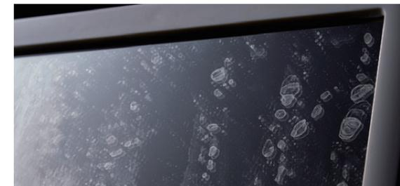
【実験方法】 ガラス板に約1L/分の条件で試験水を流水。流水、乾燥各1時間を1サイクルとし、100サイクル経過後のカルシウム付着量を電子プローブマイクロアナライザーを用いて測定。
