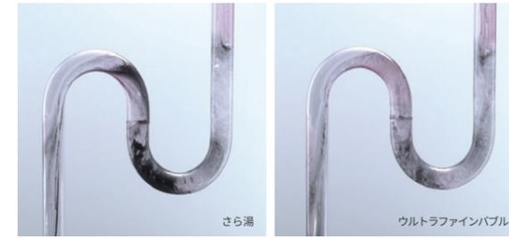
【実験方法】 排水管に疑似汚れを溜め、流量7L/分で通水。
