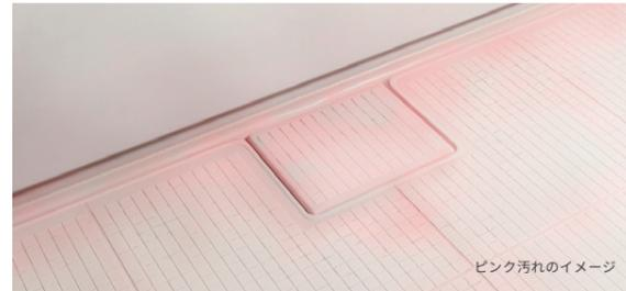
【実験方法】 赤色酵母のピンク汚れ (Rhodotorula (ロドトルラ) sp. [KSS-0802]) をサンプルに塗布し、10L/分、1分の条件で試験水を流水。その後、サンプルの残存菌数を測定。
